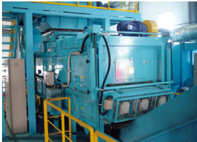
ゴミ袋と中身を分離し回収する破集袋機
